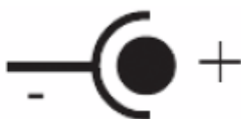
Illustration 2 : polarité du câble d'alimentation.
