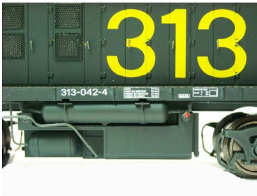
Depósitos combustible nuevos, ambos lados diferentes
