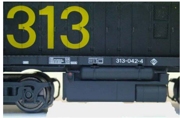
Depósitos combustible nuevos, ambos lados diferentes
