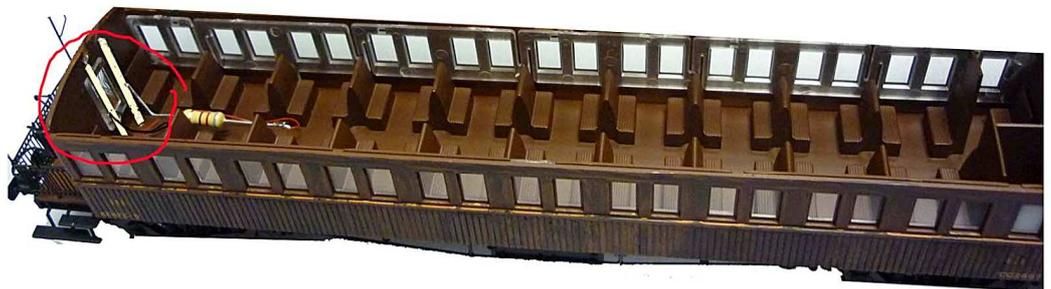
6- Soldar los dos cables en las dos varillas de latón del interior del coche, intercalando la resistencia en el cable rojo según indica en las instrucciones del farol
