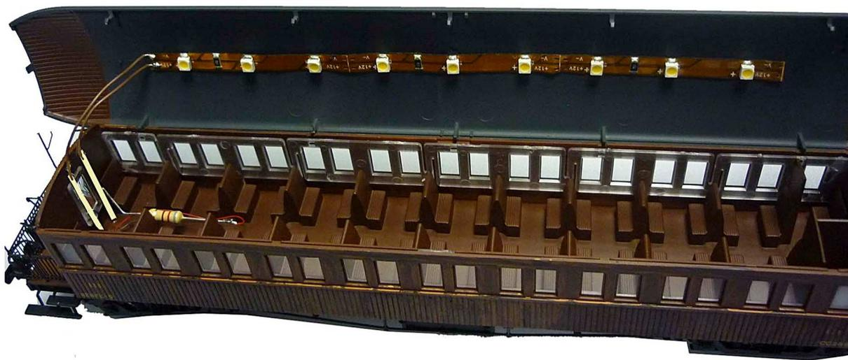
Pegaremos un trozo de 15cm de la tira de leds en el techo, soldando los dos cables a las dos varillas de contacto del vagón
