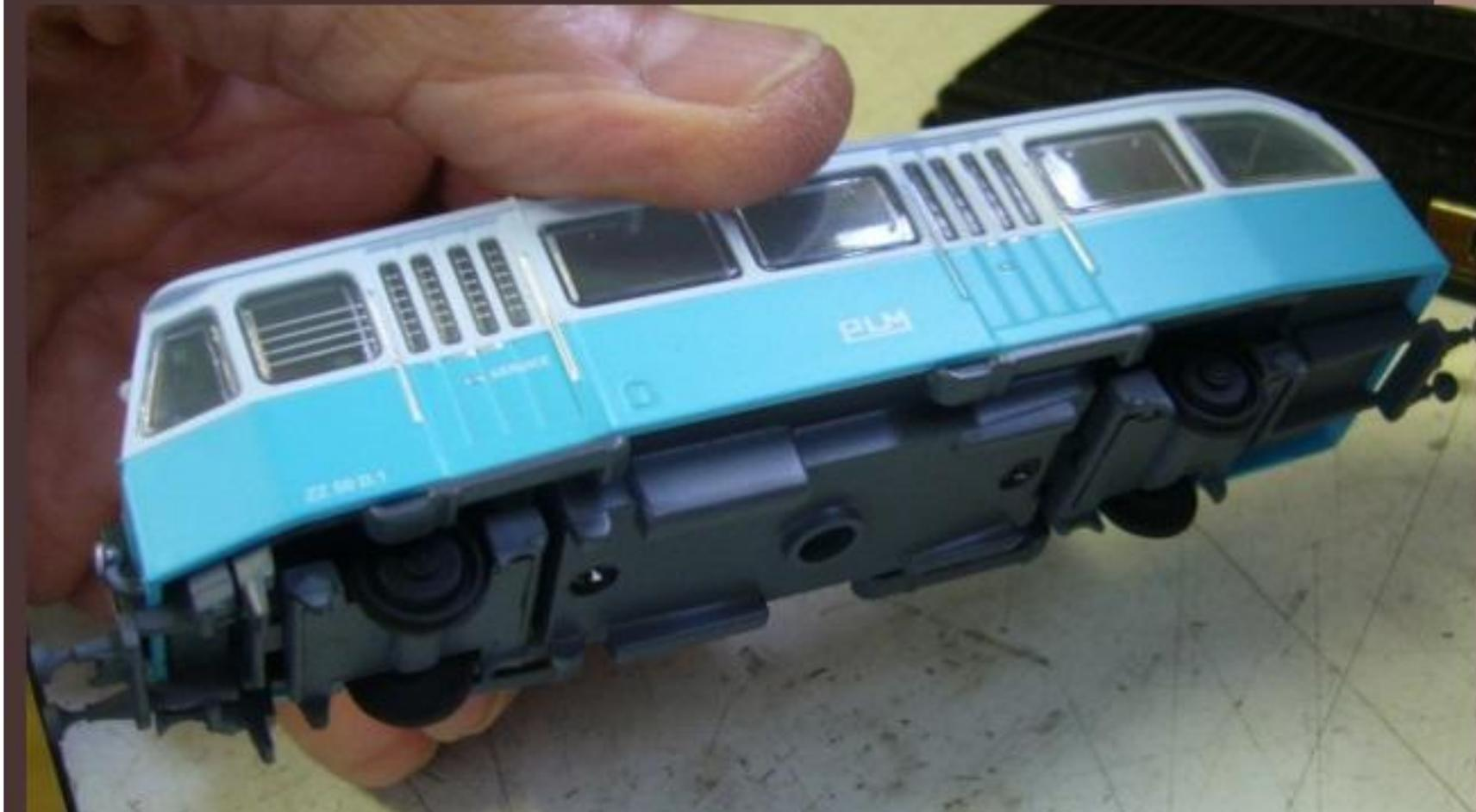
Un rapide coup d'oeil sous le châssis métallique montre la disposition des deux essieux montés sur des supports mobiles articulés sur un axe central, sans doute pour assurer une meilleure tenue sur la voie??? étonnant pour un modèle statique!!!!
