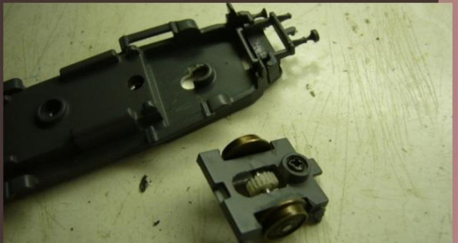
Le châssis doit être fraisé au niveau de l'axe d'articulation du support d'essieu afin de laisser le passage à la vis sans fin.
