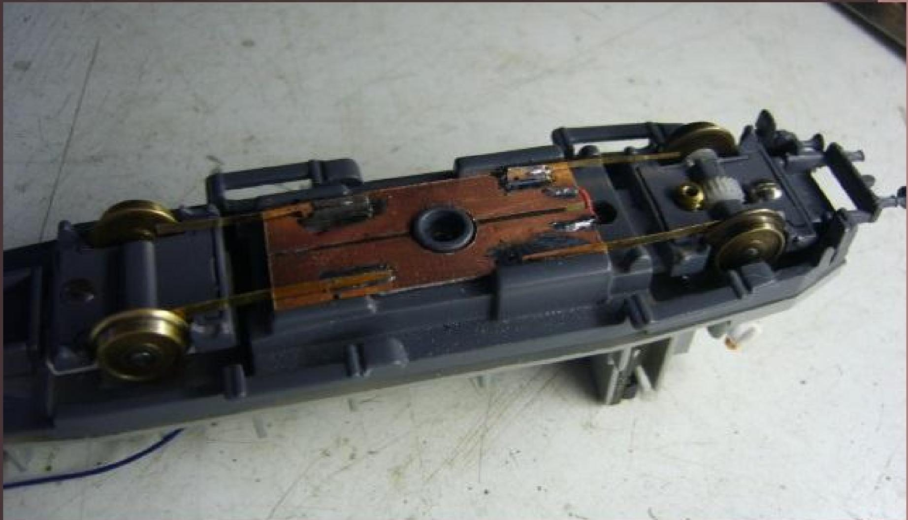
des lamelles en chrysocal de 1/10ème de mm découpées et mises en forme sont soudées sur les deux pistes, assurant un contact électrique souple sur les quatre roues
