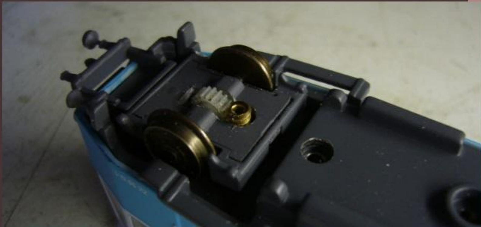
détail de la transmission, il reste à vérifier si l'entraînement sur un seul essieu moteur sera suffisant, la pose de bandage d'adhérence étant à écarter compte tenu du nombre limité de roues qui seront chargées de capter le courant.
