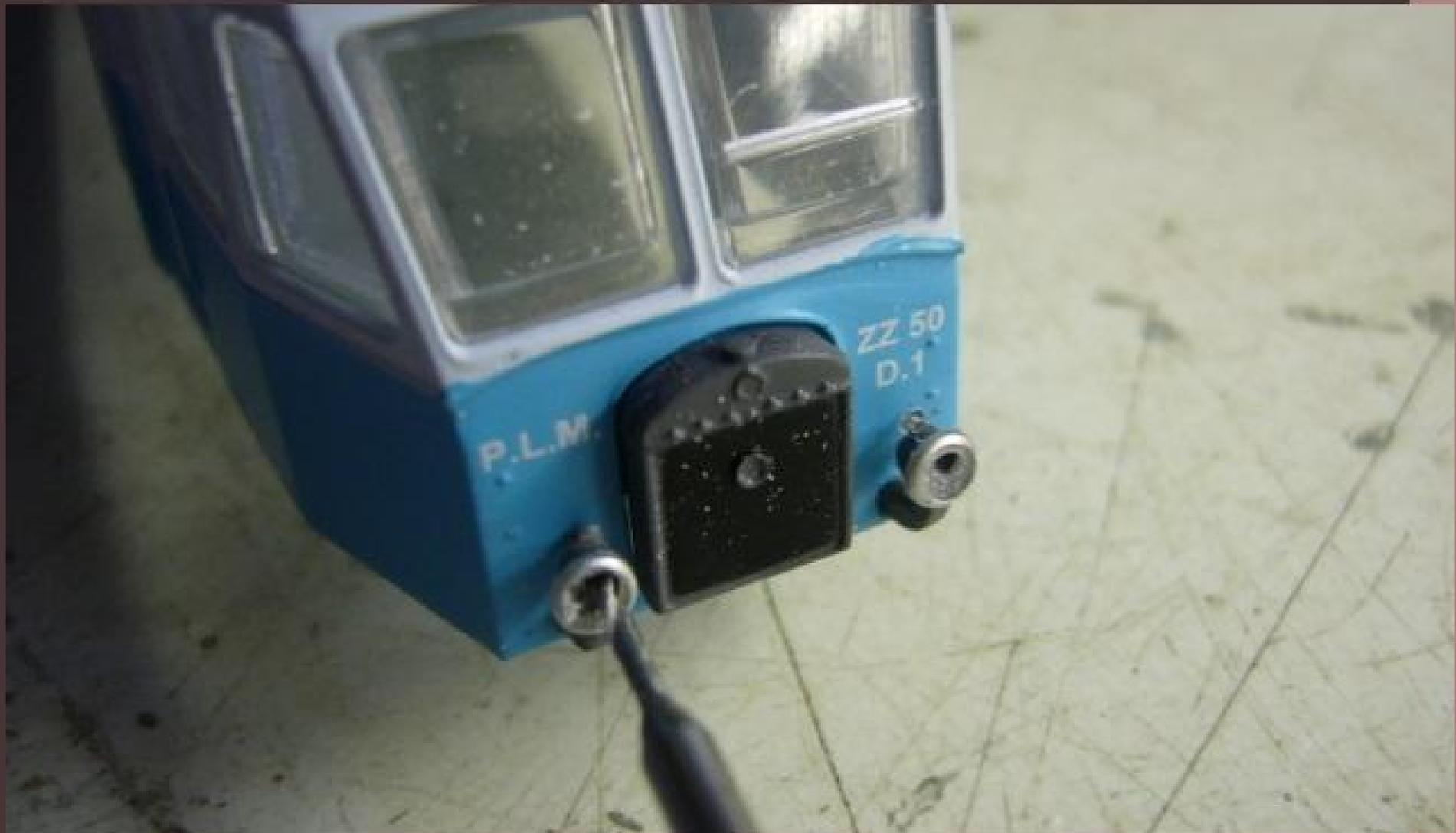
les optiques de phares ont été percées de part en part et fraisées pour installer des leds CMS, opération délicate car les supports sont très fragiles.
