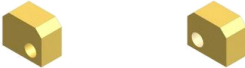
**Face Draft:** Cambia el ángulo de salida de una cara por medio de la determinación de la dirección de desmoldado, el ángulo requerido y la dirección de inclinación.
