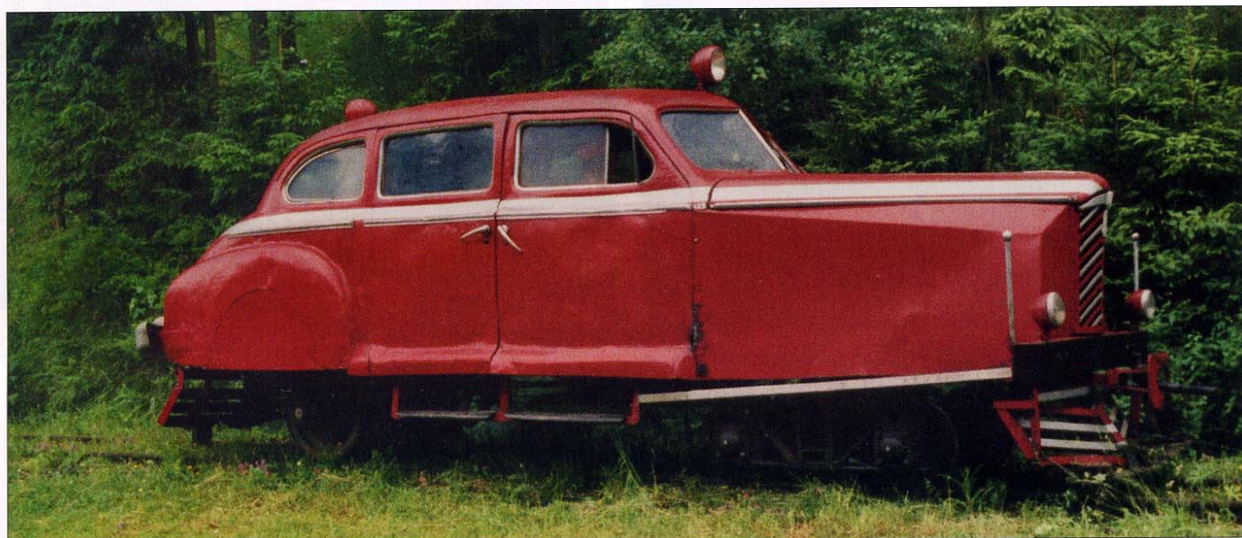
Sur la ligne forestière maintenant disparue de Toplita à Borsec (CFF), cette luxueuse voiture d'inspection a été photographiée le 23 juin 1996. C'est une ZIS 110, conçue avec de l'outillage Packard Super d'origine américaine, elle a été construite dans la région de Moscou entre 1946 et 1956.
