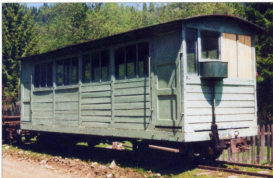
Camion roumain à deux essieux M461, en fait un Gorki soviétique fabriqué sous licence, transformé par les CFR pour le transport d'ouvriers ou de produits craignant l'humidité, sur l'ancien réseau de Tirgu Mures, à Milas, le 20 juillet 1995
