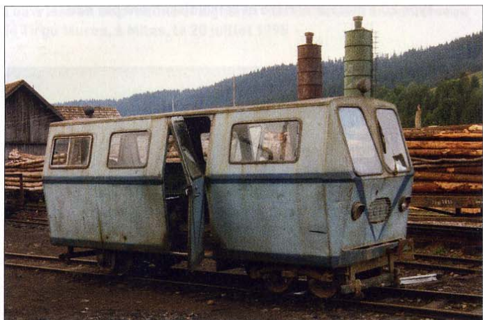
Autorail à trois essieux, un bogie porteur à l'avant et un essieu moteur à l'arrière, une belle construction des CFF, à Moldovita, le 17 août 1992.
