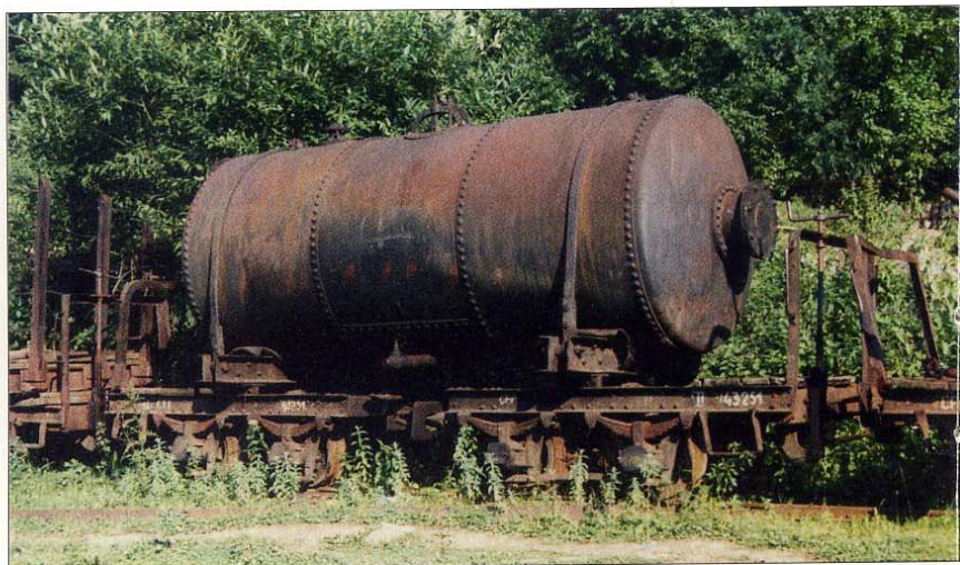
Citerne récupérée, montée sur deux wagonnets accouplés, au dépôt de Viseu de Sus, le 19 juillet 1995.
