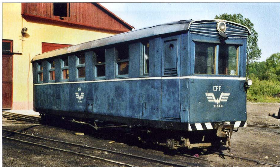
Autorail au dépôt de Viseu (CFF), construit en utilisant une ancienne voiture à voyageurs et dont un seul bogie est moteur. Le 24 mai 2006.
