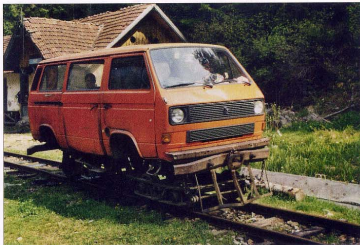
Automotrice pour Izvorul passant la station de Valea Babii (CFF, Viseu), le 16 mai 2007. C'est une fourgonnette VW type 2C à moteur arrière et refroidissement par eau.
