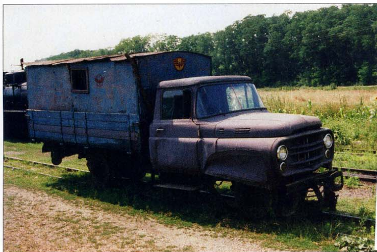
Camion roumain à deux essieux M461, en fait un Gorki soviétique fabriqué sous licence, transformé par les CFR pour le transport d'ouvriers ou de produits craignant l'humidité, sur l'ancien réseau de Tirgu Mures, à Milas, le 20 juillet 1995
