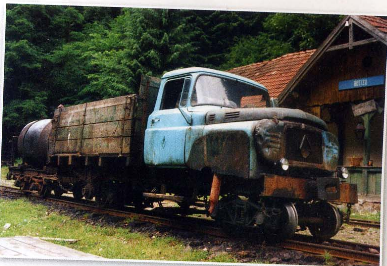
Camion à bords hauts tractant un wagon-citerne en gare de Botizu sur la ligne de Viseu de Sus, le 25 mai 1996. Notez le pot d'échappement sous l'aile avant droite. Le camion est probablement un Brasov SR 113 équipé d'un V8 essence de 140 cv !
