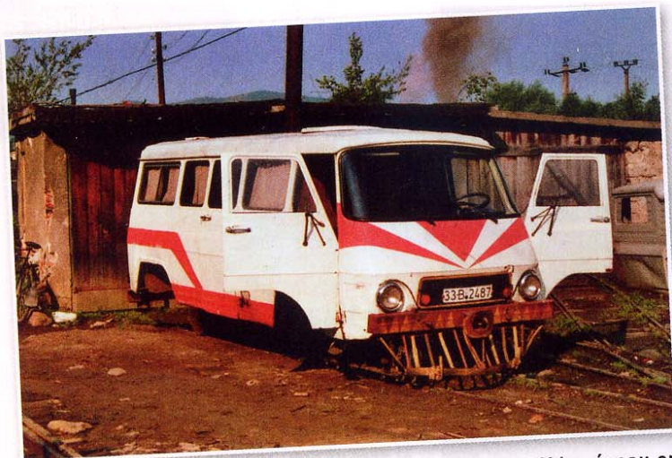
Autorail au dépôt de Viseu de Sus, une fourgonnette TV le réseau en possédait trois, le 19 juillet 1995. Presque tous les véhicules transformés reposent, à l'avant, sur un bogie et, à l'arrière, sur l'essieu moteur modifié.
