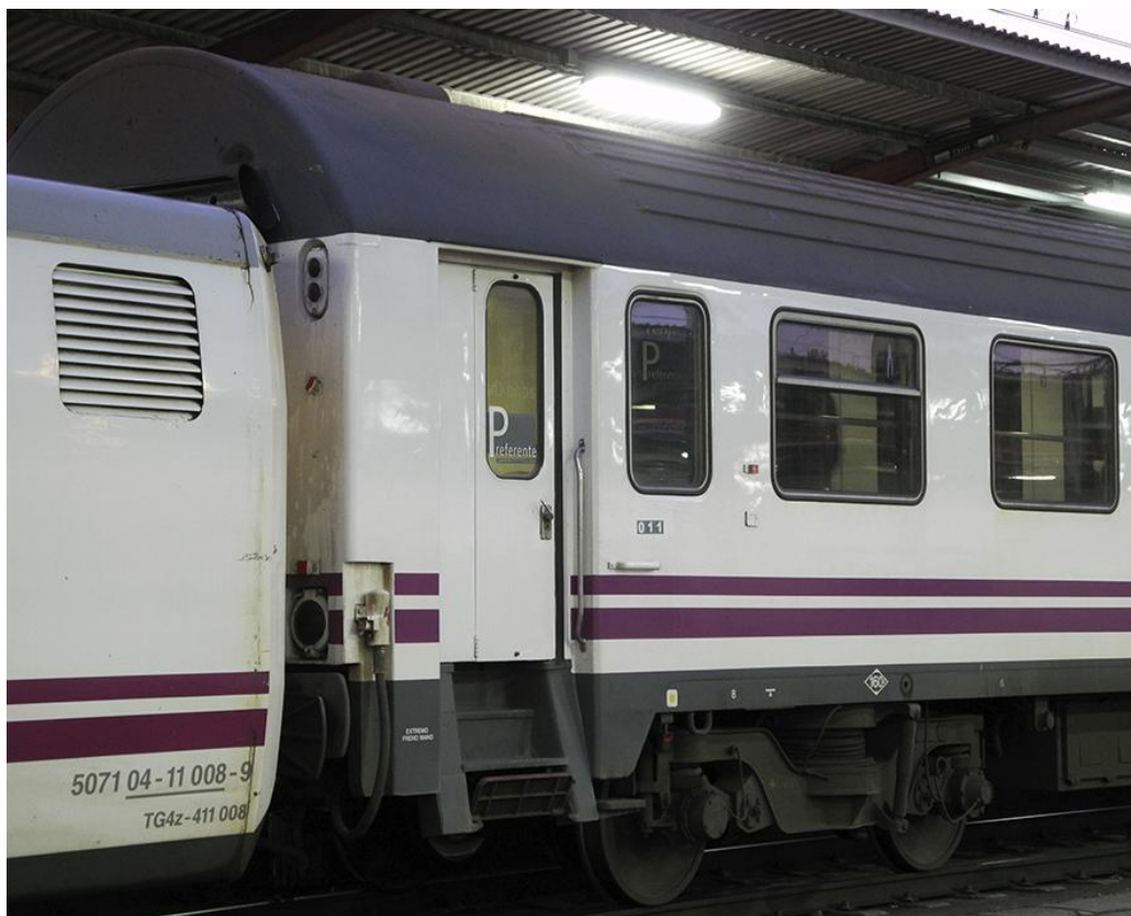
Detalle del enganche entre el furgón y el coche
