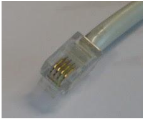
Clavija montada RJ9 con 4 hilos
