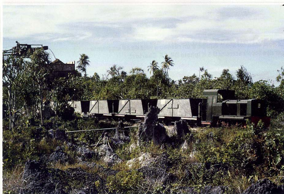
Après la seconde guerre mondiale, les trains de minerai sont tractés par des locotracteurs Billard T100 D. Initialement prévus pour la ligne Maginot, ils ont été tropicalisés pour Makatea (photo DR J.F. Charles).
