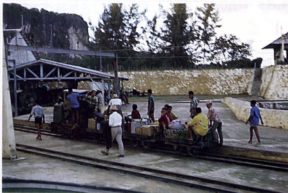
Le port était lui aussi équipé d'un réseau à voie de 60 emprunté par des locotracteurs O & K (photo DR J.F. Charles).
