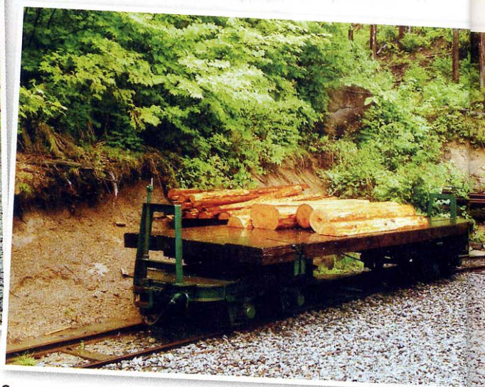
Sous ce plat avec chargement de bois, on reconnaît bien les deux lorries porteurs. (photo Éric Binamé).
