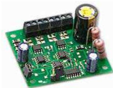
El Digitrax DS52 operará dos desvíos bipolares individuales de 2 hilos. Su descarga capacitiva proporciona suficiente carga a los decodificadores, pueden ser separadas o secuenciales.
