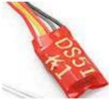
El Digitrax DS51K1 se puede montar debajo del módulo T-TRAK por debajo del desvío correspondiente. Está clasificado en 0,5 amperios y mide 8,11mm x 12,94 mm x 3,88 mm. Los cables naranja y gris del decodificador están conectados al motor de desvío, y los cables rojo y negro se conectan a la potencia de la pista (tal vez utilizando UniJoiners). Después de la instalación se programa el decodificador a la dirección deseada siguiendo las sencillas instrucciones proporcionadas por Digitrax.
