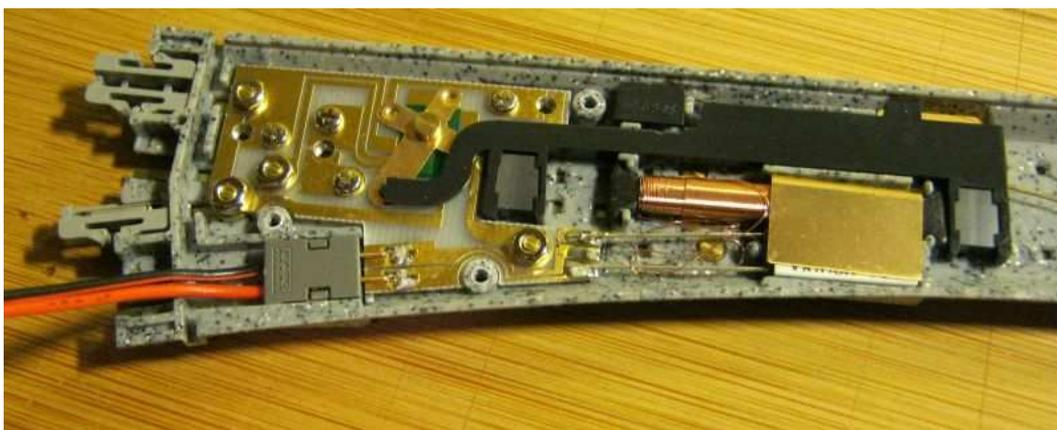
La Figura 2 muestra los mensajes y los tornillos marcados (los tornillos operativos están en las posiciones DCC de mi instalación, enrutamiento de energía y el corazón electrificado apagado).
