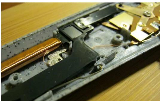
Normalmente, cuando se toma el cambio de vía desarmado, este alambre va a salir del agujero. Recuerde colocar de nuevo el alambre de cambio de vía antes de volver a montar. –Recomendamos poner una gota de pegamento, dejamos secar- para que siga siempre en su sitio mientras lo manipulamos.-
