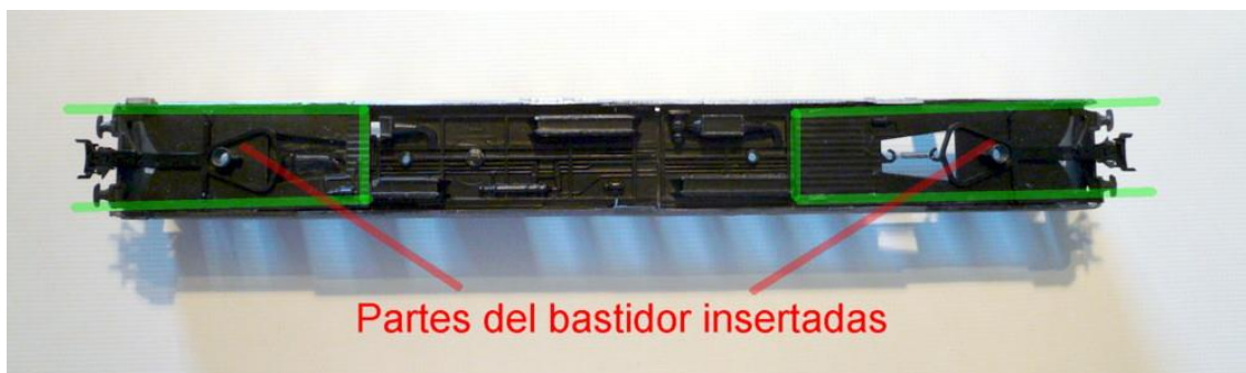
Foto nº 9 – Bastidor ( suelo de la caja ) una vez pintado de negro.
