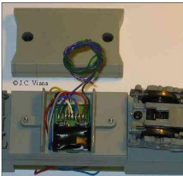
Los cables verde y violeta que aparecen en la foto corresponden a funciones auxiliares del decodificador utilizado (un LE-130 de Lenz®) que no se utilizan y quedan sin cablear.
