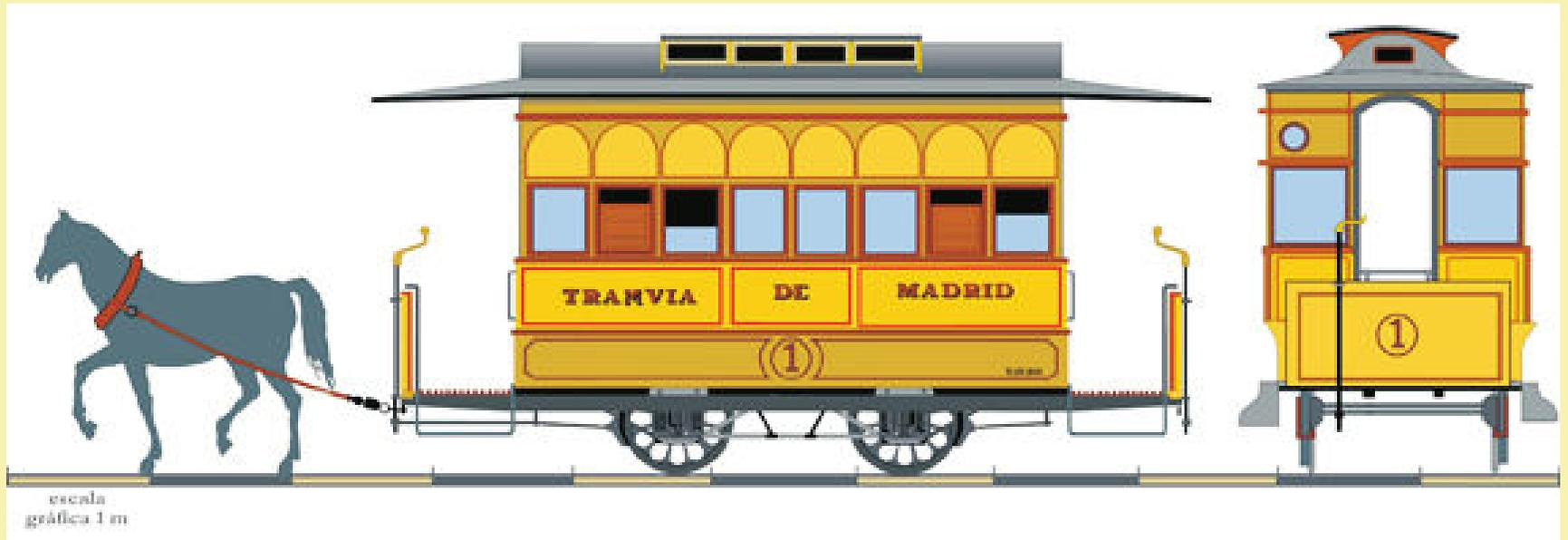
1876. Tranvía de tracción animal. A los pocos años de su puesta en servicio, el segundo piso de los tranvías fue eliminado, quedando los coches con esta configuración de un solo piso hasta la llegada de la electrificación.
