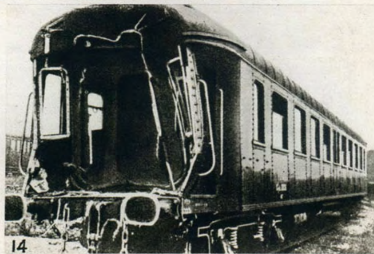
FIG. 14. UNE VOITURE METALLIQUE APRES UN TAMPONNEMENT A 60 KM. A L'HEURE (CLICHE « OSSATURE METALLIQUE ».)
