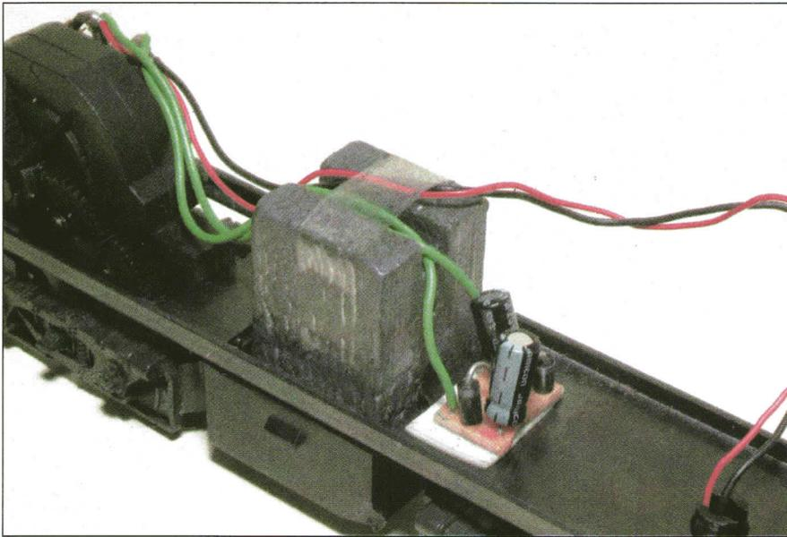
El circuito antichispas montado sobre una placa de circuito impreso y sujetado al chasis por un adhesivo de doble cara, los cables verdes son los que unen a éste con los dos bornes del motor.
