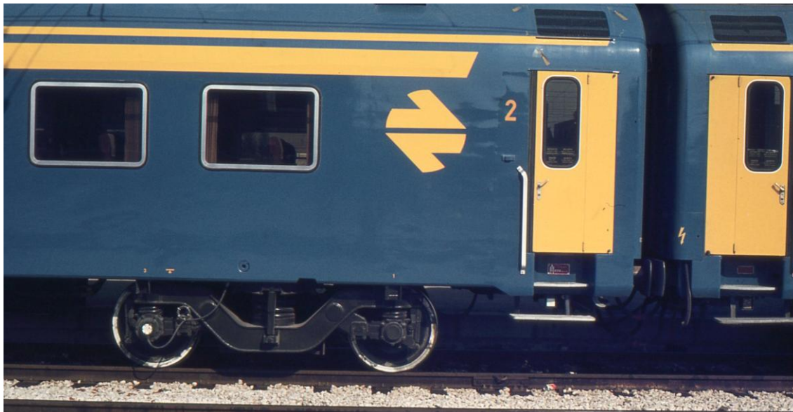
Foto realizada para observar detalles en el bogie FIAT F80SL.
