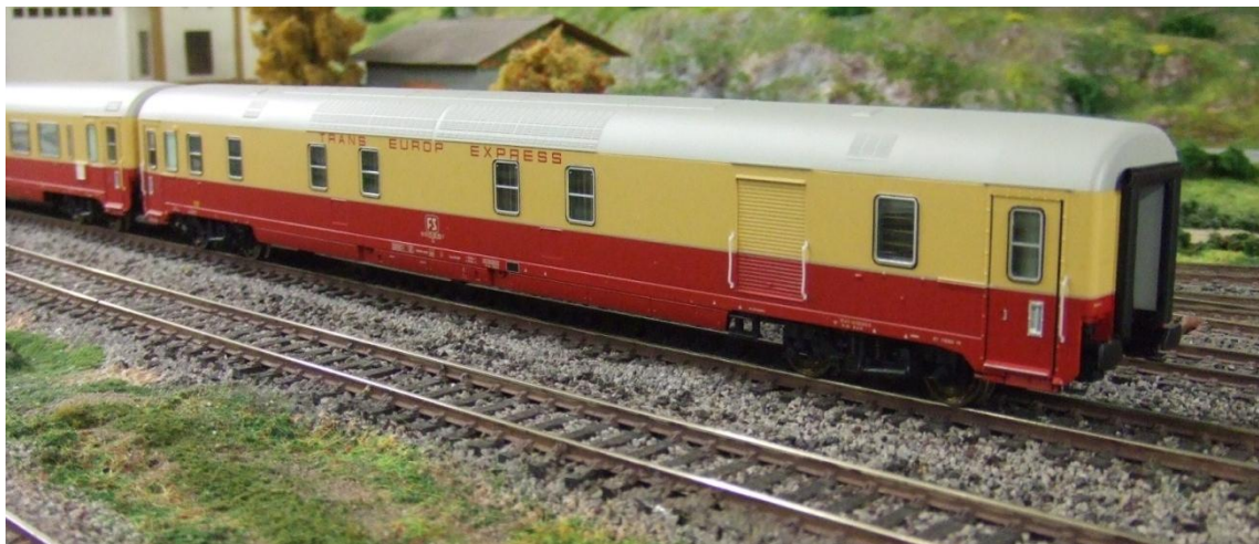
Furgón convertidor Dz lado equipamiento
