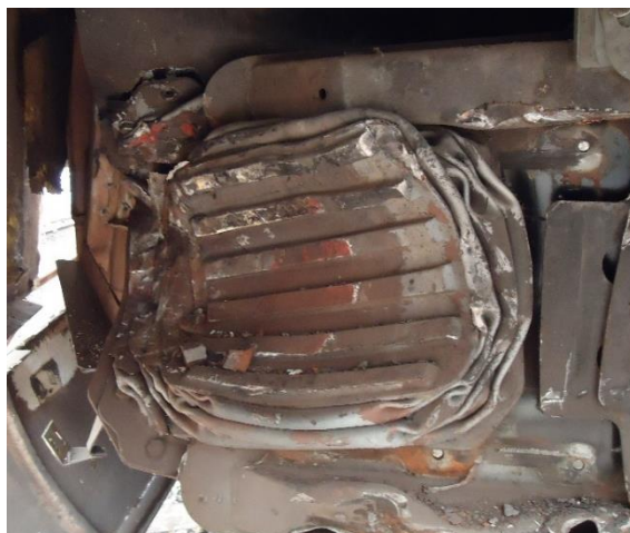
Figura 17: estado de los dispositivos anticabalgamiento (o antichoque) del tren tras la colisión
