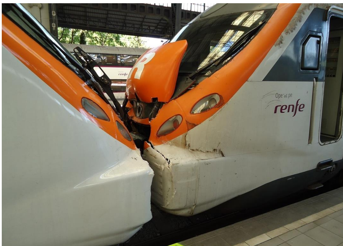
Figura 9: daños en el acoplamiento entre las dos unidades
