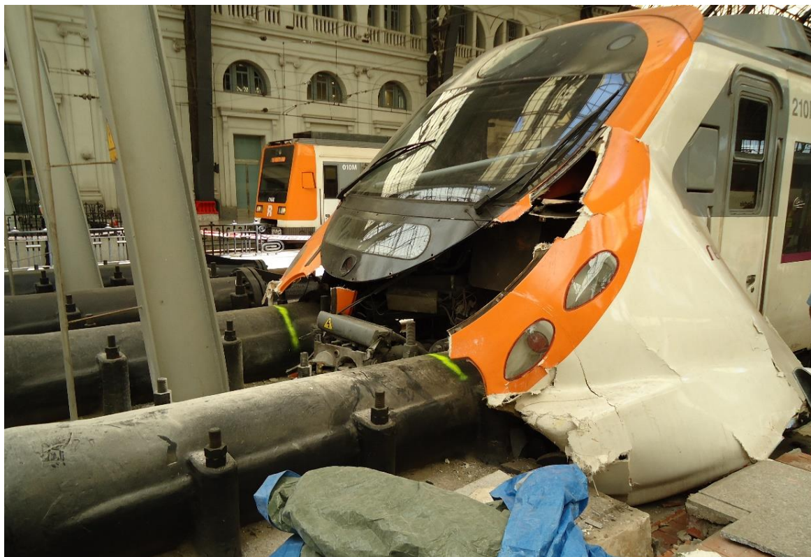
Figura 4: estado del tren 25502 tras empotrarse en la topera de la vía 11
