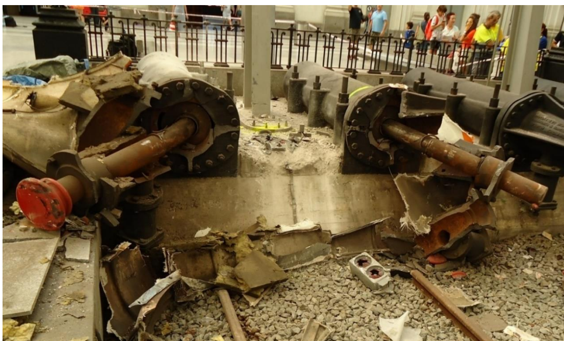
Figura 6: daños producidos en la topera de la vía 11
