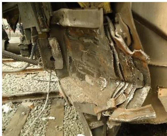
Figura 17: estado de los dispositivos anticabalgamiento (o antichoque) del tren tras la colisión
