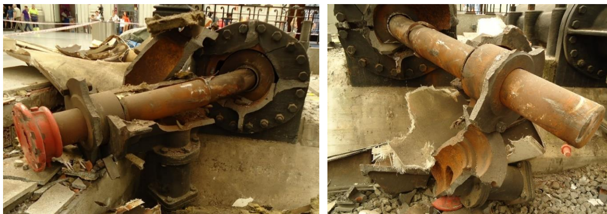
Figura 15: émbolos doblados y piezas de fundición rotas (una vez retirado el tren)
