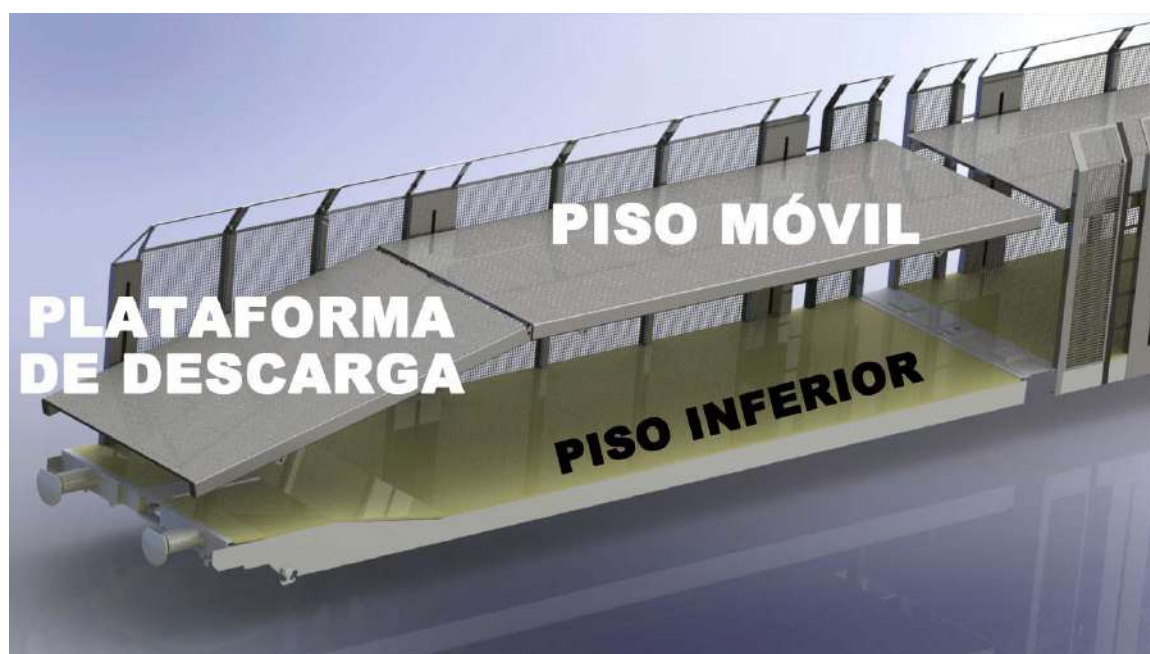
Figura 32 - Distintas partes del piso superior de un semivagón
