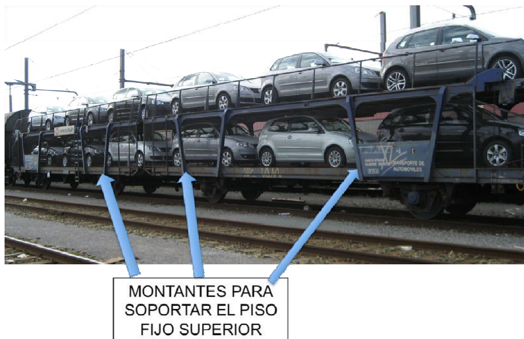
Figura 48 - Montantes de un vagón con piso superior fijo
