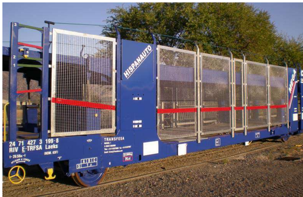
Figura 47 - Diferencias entre los montantes y las protecciones anti-vandálicas
