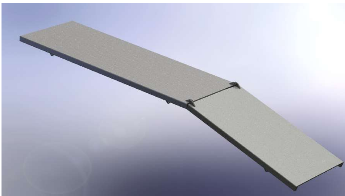
Figura 46 - Diseño 3D del piso superior del vagón
