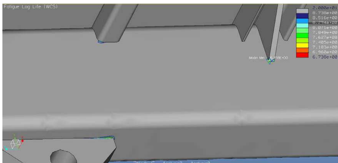
Figura 124 - Detalle de la vida a fatiga con carga máxima en la plataforma
