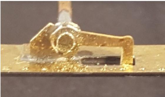
Separe las piezas 82 de la plancha de la locomotora sobre la base pieza 53, y las 113, 114 y 117 de la plancha de las bielas móntelas sobre las 82 con la varilla de  $\varnothing$  1.2mm, que se suministra, como se aprecia en las fotografías, el sobrante de la varilla córtelo a ambos lados de las piezas para que al encajar el bastidor con el motor, éste
