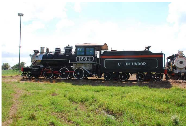
Figura 19. Locomotora Vulcan 1564, 2449, 2-6-0 del central Ecuador (antiguo Baraguá), Ciego de Ávila, llamada La Educadora por su uso en la formación del personal ferroviario, 2010
