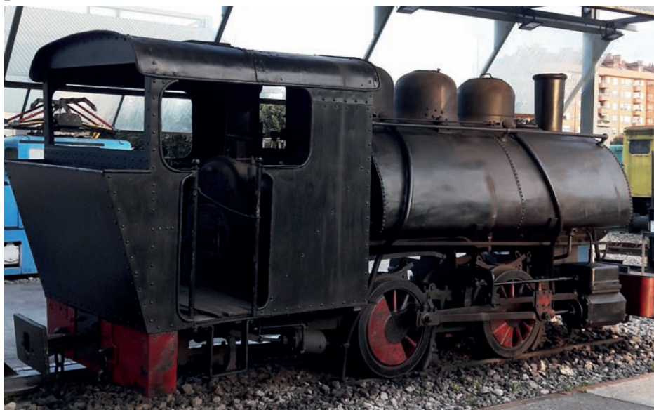
Fig. 17. Locomotora 020ST con tanque de albarda. Tranv a de Santuyano a Caba aquinta. Museo del Ferrocarril de Asturias (JHA, 26-10-2016).
