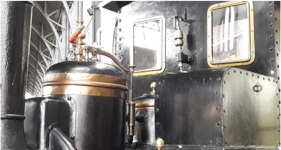
Fig. 13. Detalle de domo, válvula y silbato (JHA, 1-12-2016).
