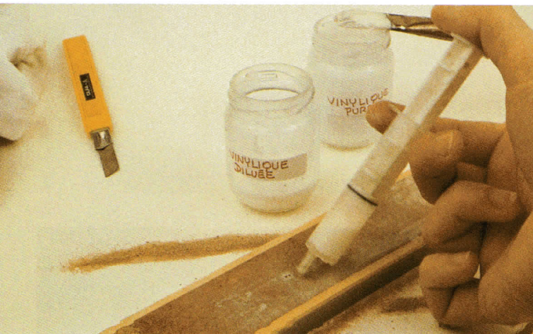
12. Fase de encolado clásico con cola blanca vinilica disuelta.
