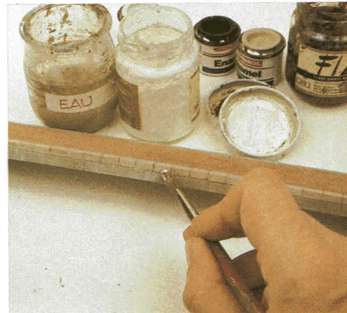
18. La pátina se efectúa con la ayuda de una pintura acrílica muy diluida (en este caso, sombra natural).
