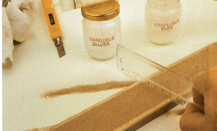
11. Operación de nivelación del material granulado de revestimiento, con la ayuda de una regla.
