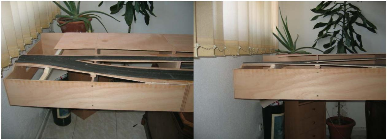
Detalle de rampas del módulo 1, instalados los soportes de las vías.
