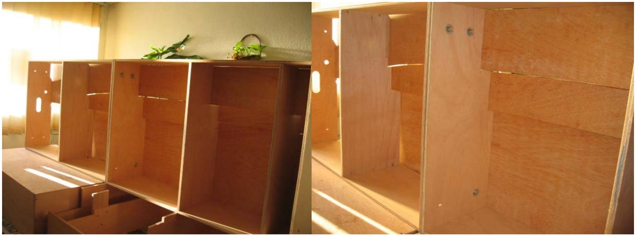
Aquí podáis ver el bastidor de los dos módulos, total 180 cm., con los niveles de las rampas cortados en los perfiles y el detalle del ensamblaje. (Falta un tornillo por poner)
