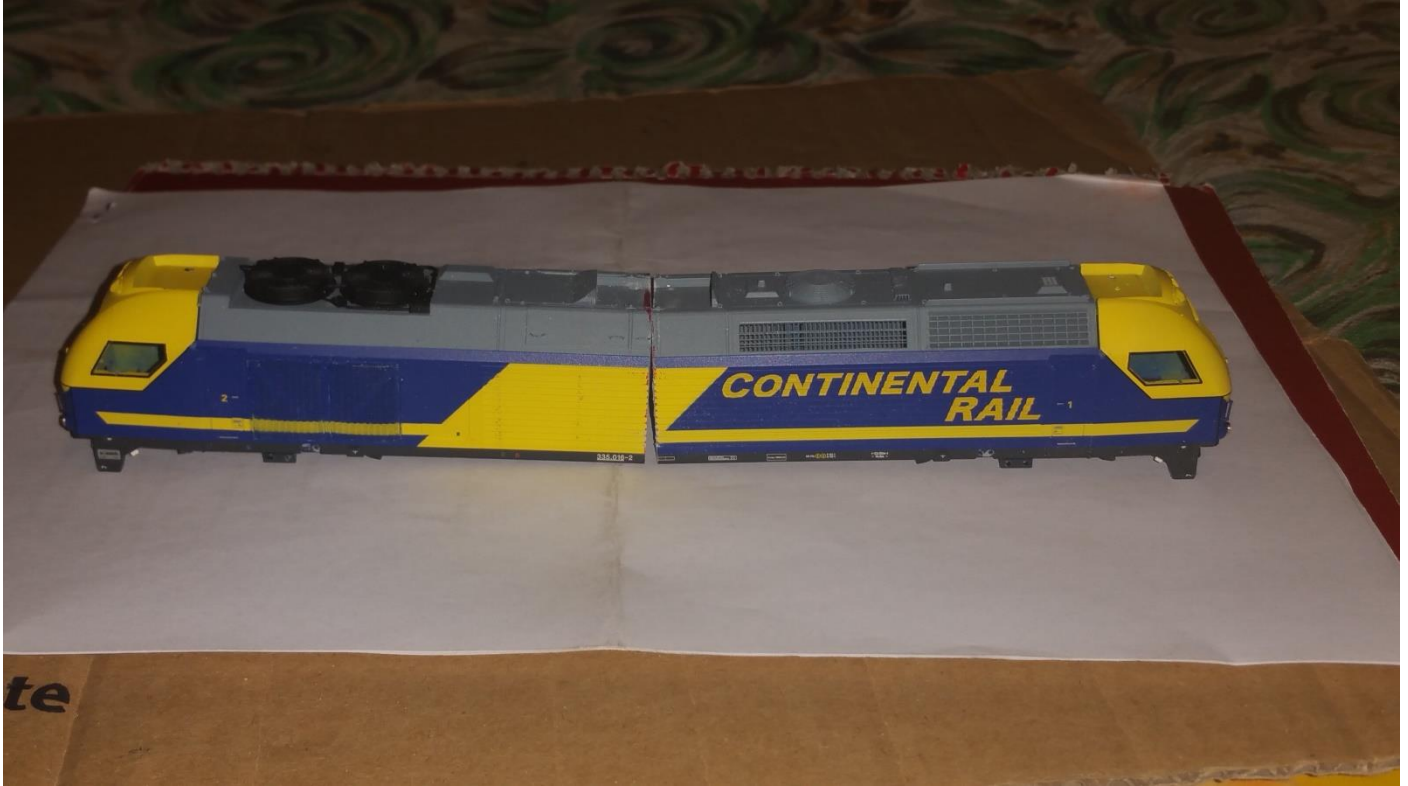
FOTO 3 Aquí se ve la presentación de ambas caras y se ven las imperfecciones de los cortes, aquí manda la carcasa que está a la derecha, es la primera que hay que dejar las paredes del corte lisas para la unión , a partir de aquí se va arreglando la parte de la carcasa de la izquierda.
