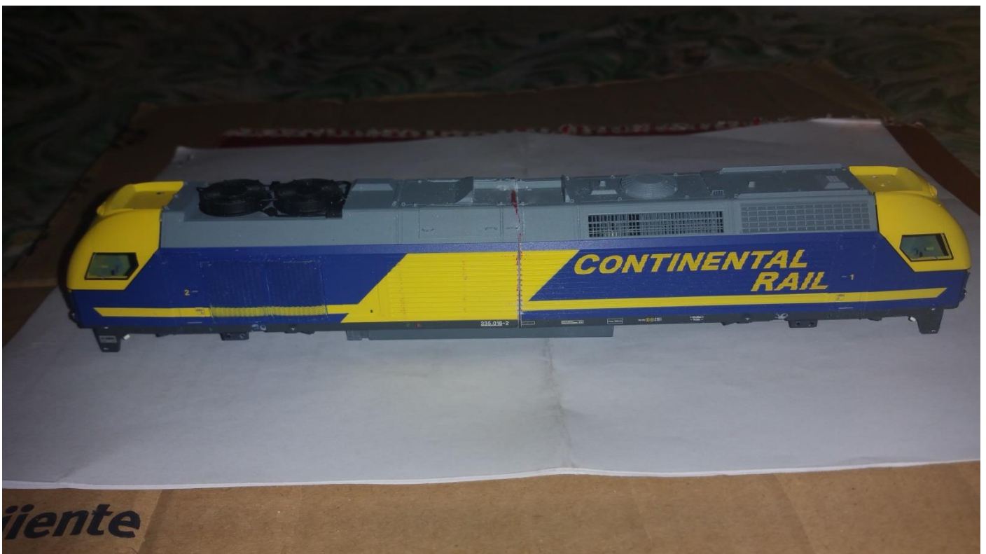
FOTO 4 Aquí está ya con el bastidor, ya va pareciendo una 334, cuando ya tengas lijada la parte de la izquierda y te coincida, pues habrá que quitar el exceso de partes del techo, los huecos del bastidor para anclar la carcasa izquierda se hace cuando ya tengas unida la carcasa, ya que puede haber un error de medidas y sería fatal. Debes de vigilar también por debajo y ya lo veras, que la carcasa no toca con el bastidor por la parte del morro, como tienes una parte de la carcasa que encaja perfectamente pues lo puedes ver, pues esa mínima separación también la tienes que hacer en el lado izquierdo, ok y ya pasamos a la fase de pegado.
