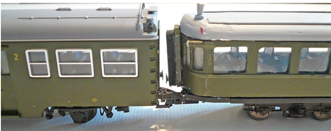
Foto nº 25 – Acoplamiento entre el último coche y una “yenka” de refuerzo.
