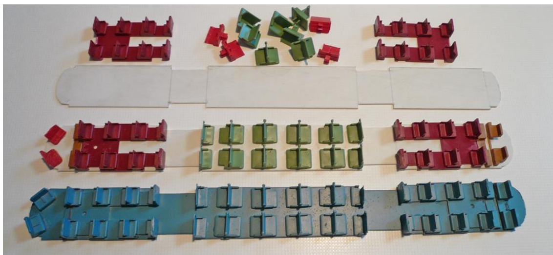
Foto nº 17 - Los 3 interiores en distintas fases de construcción.
