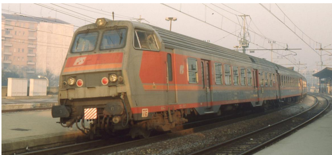
Milán-Lambrate 4-12-89 : un coche semi-piloto MDVC, librea MDVE, apto a pilotar eléctricas ( "TE" ), en la cola de un "diretto".
