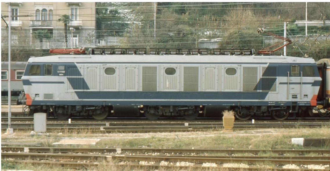
Como-San Giovanni 3-12-89 : esta E-633 presenta la disposición original de techo, con pantógrafos Faiveley y reóstato largo de 15 "racks".
