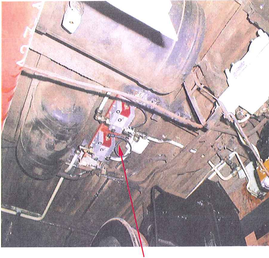
Electroválvulas de antibloqueo
