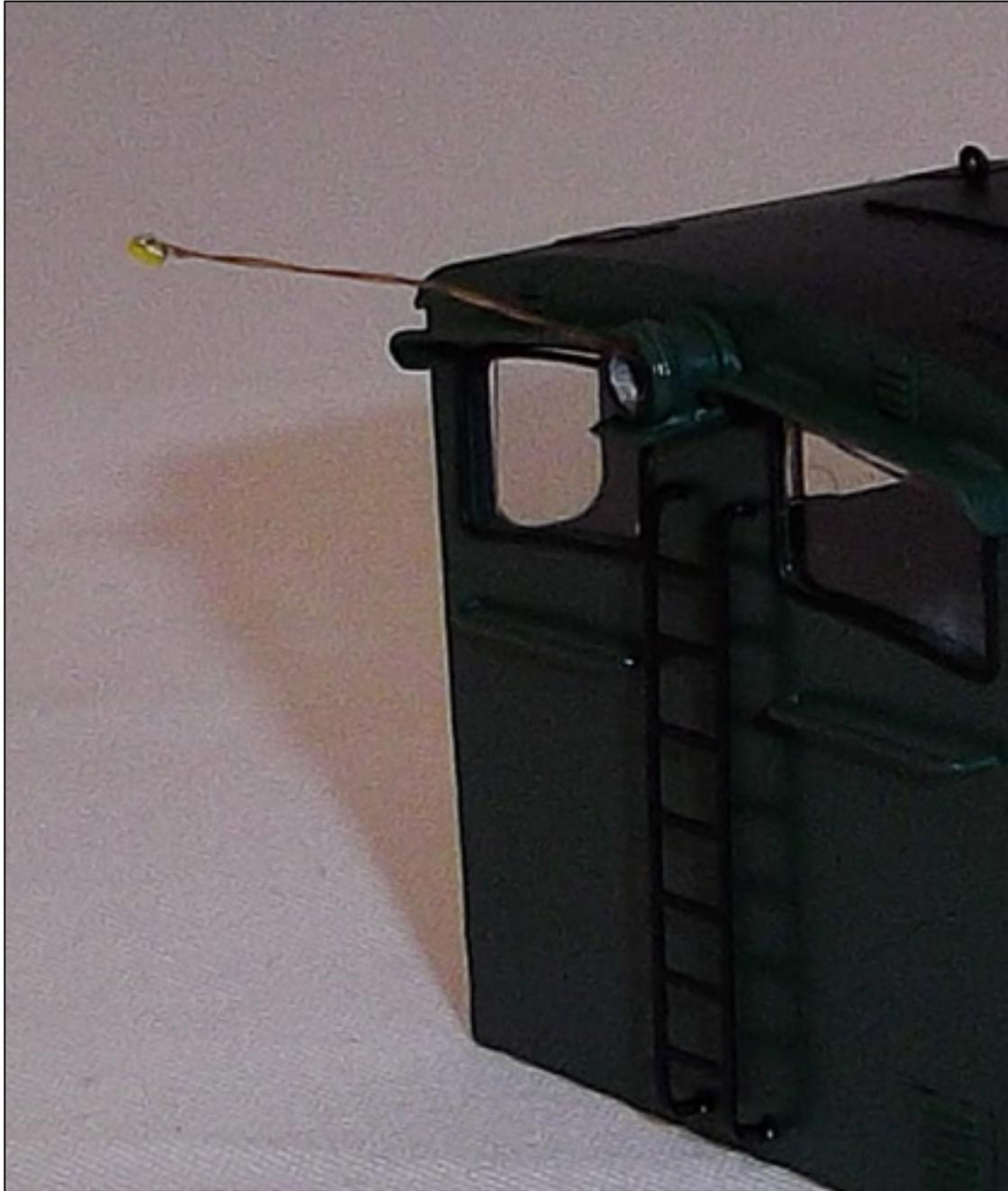
Tras pintar de plata el interior de los focos procedemos a trenzar con cuidado el hilo del led y los introducimos a través del foco.
