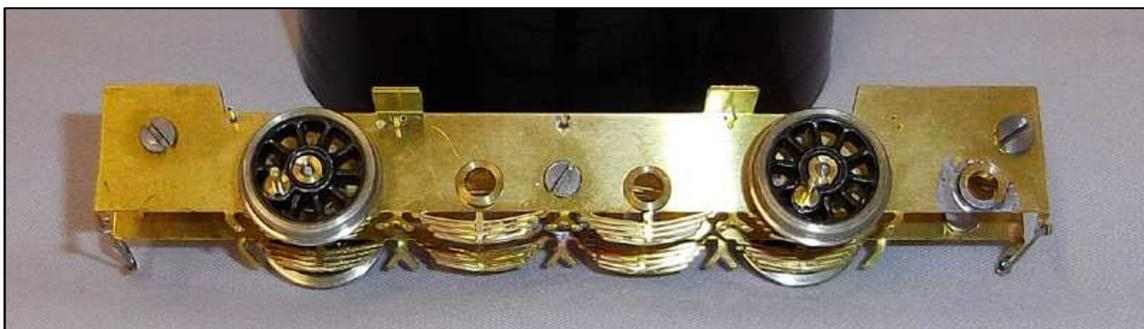
Ya podemos colocar los 4 casquillos de los ejes centrales, nos aseguramos de que se desplazan arriba y abajo en los ojales del chasis con suavidad, pero no hacia delante o atrás, solo han de hacerlo verticalmente, así que cuidado con la lima si la necesitáramos.
