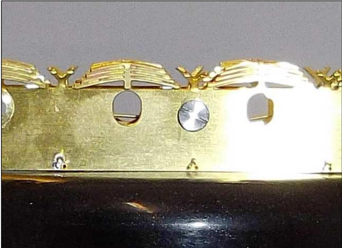
Con esta imagen apreciamos la varilla a través de los agujeros de los ejes, esta varilla los presionará hacia abajo y los agujeros ojivales de los ejes permitirán que los ejes suban y bajen según lo requiera la vía.
