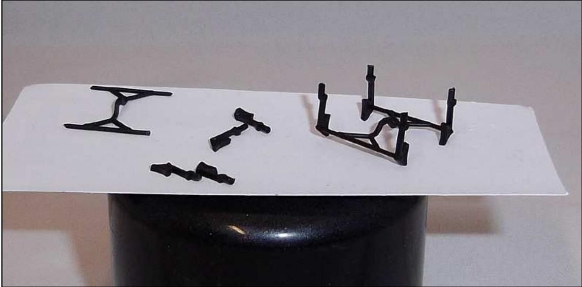
Vamos con las zapatas de freno, se han realizado en plástico, pues así nos permiten colocarlas lamiendo las ruedas, permiten movilidad y sobretodo evitamos cortocircuitos, muy peligrosos sobretodo en modelos digitales.
