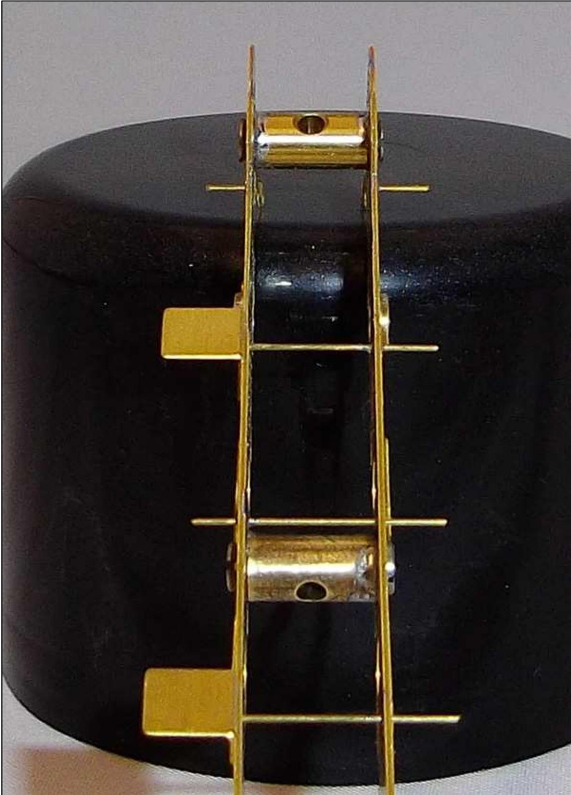
Ahora habremos de cortar la parte interior de la varilla delantera y dejar a ras del interior del chasis, pues es el alojamiento de la caja de engranajes del motor, y nada debe tropezar en ese sitio.
