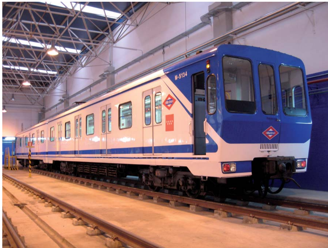
Unidad M-5134/M-5133, una de las dos que fueron transformadas en 1991 de coches remolques serie 5000-3ª. Depósito de Laguna.
