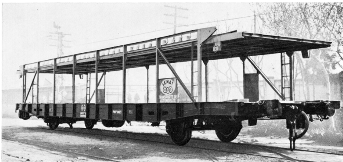
Vagón para el transporte de automóviles de la Sociedad de Estudios y Explotación de Material Auxiliar de Transportes / Madrid (SEMAT)
