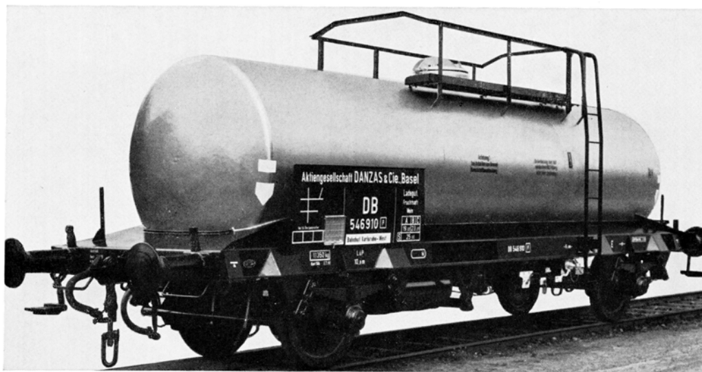
Vagón cisterna para el transporte de zumo de la Danzas & Cie, Basilea
