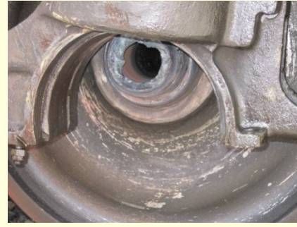
Exemple de rupture de fusée sur TGV Duplex (à noter l'essieu creux pour obtenir un gain de masse).
