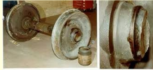
Rupture de fusées, boîtes d'essieux à bain d'huile à gauche, boîte à rouleau à droite avec roues monobloc.
