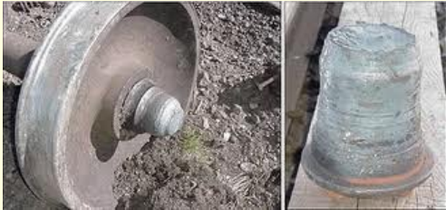
Rupture de fusées, boîtes d'essieux à bain d'huile à gauche, boîte à rouleau à droite avec roues monobloc.
