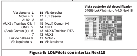
Figura 6: LokPilots con interfaz Next18
