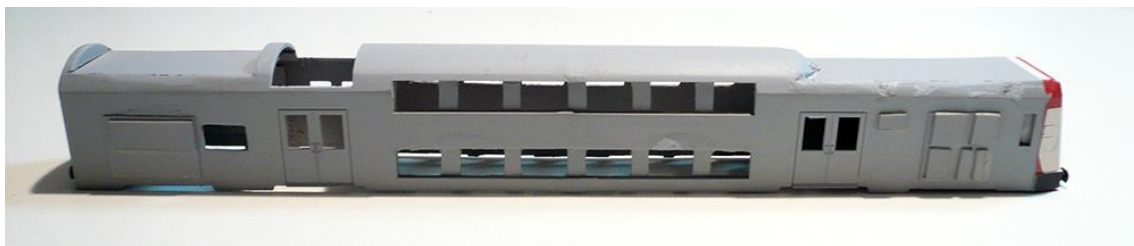
Foto nº 24 - Coche motor alargado a 1/87 exacto, con techos rebajados y ventanas individuales. Puertas todavía sin modificar anchura. Lado derecho.
