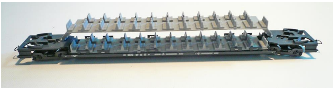
Foto nº 17 - Interior de los 2 pisos alargados del remolque intermedio.
