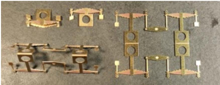
Soldar las piezas 23 y 24 por el interior y posicionar en el bastidor ayudándose por los cojinetes que se sirven para los ejes de tracción.
