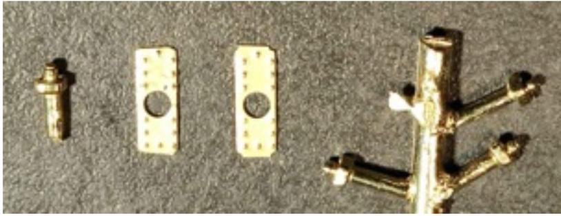
Corte las piezas 61 de la plancha de la locomotora y coja las piezas de fundición de la foto que se suministran aparte. Múltelas como se indica en la fotografía inferior. Coja las piezas de fundición tapa cilindros delanteras y múltelas como se indica en la fotografía inferior
