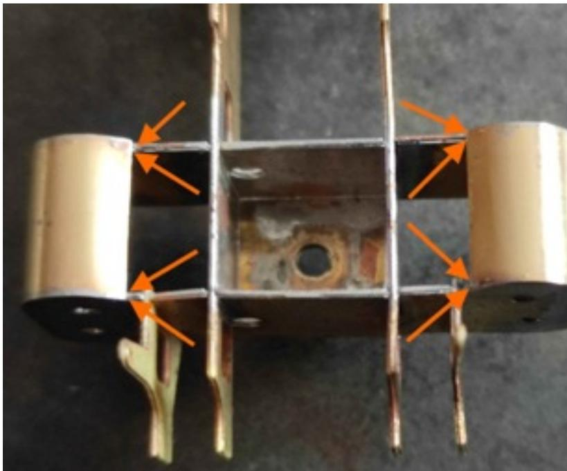
En la fotografía de la izquierda las flechas señalan los puntos de referencia para el curvado de las piezas número 21, tapas de los cilindros de los pistones. Es imprescindible que se ajusten muy bien a estos puntos.
