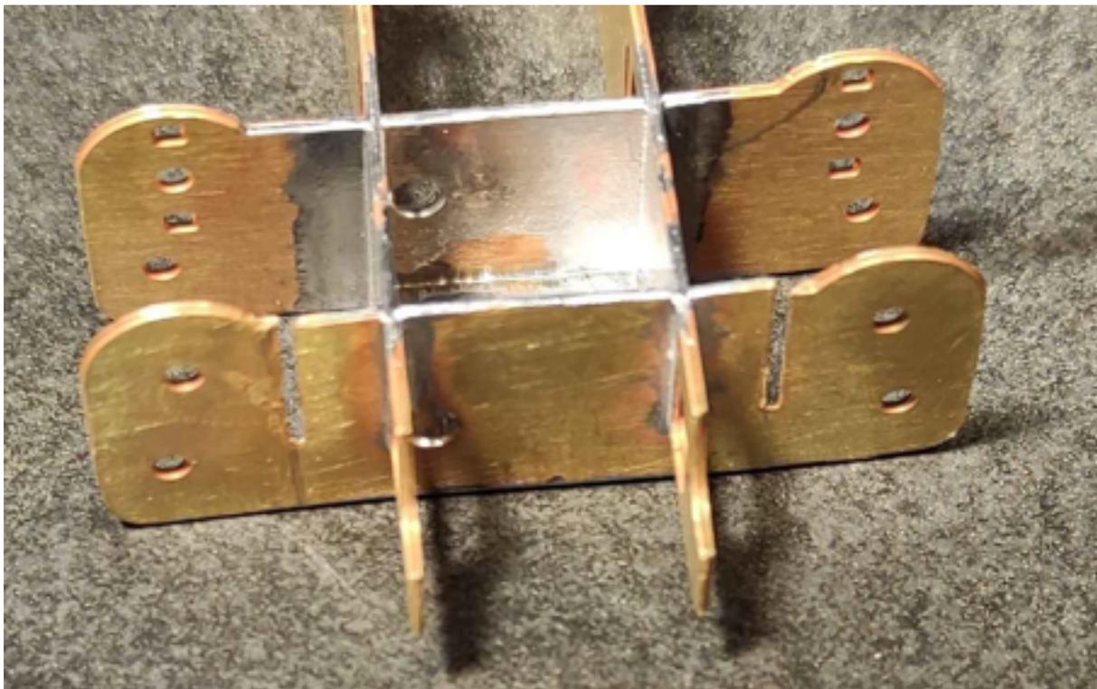
Observar como queda la soldadura después de limpiar. Una soldadura buena tiene que ser fina y brillante, desechar siempre aquella que presente pequeñas esferas de fundente ya que ésta no ha llegado a la temperatura óptima. El fundente debe correr entre las rendijas de las piezas a soldar
