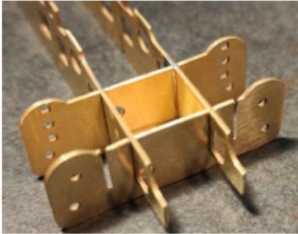
Colocar la pieza 4 y proceder a soldar todo el conjunto siempre apoyado sobre una superficie plana y comprobando que las piezas 3 y 4 están bien metidas hasta el fondo en las cartelas 1 y 2.
