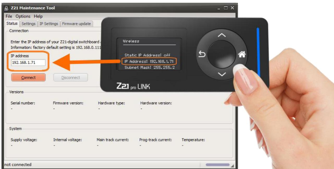
Ahora ingrese la dirección IP que se muestra en su Z21 pro LINK en la herramienta de mantenimiento Z21 y luego presione el botón "Conectar".
