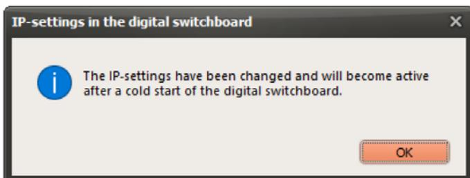
Importante: ¡La nueva dirección IP solo está activa en el Z21 después de un arranque en frío (es decir, desconectar la tensión de alimentación) en el centro de control!
