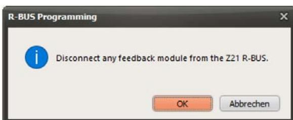
Una vez que todos los módulos estén desconectados del puerto R-BUS en el Z21, presione "OK".
