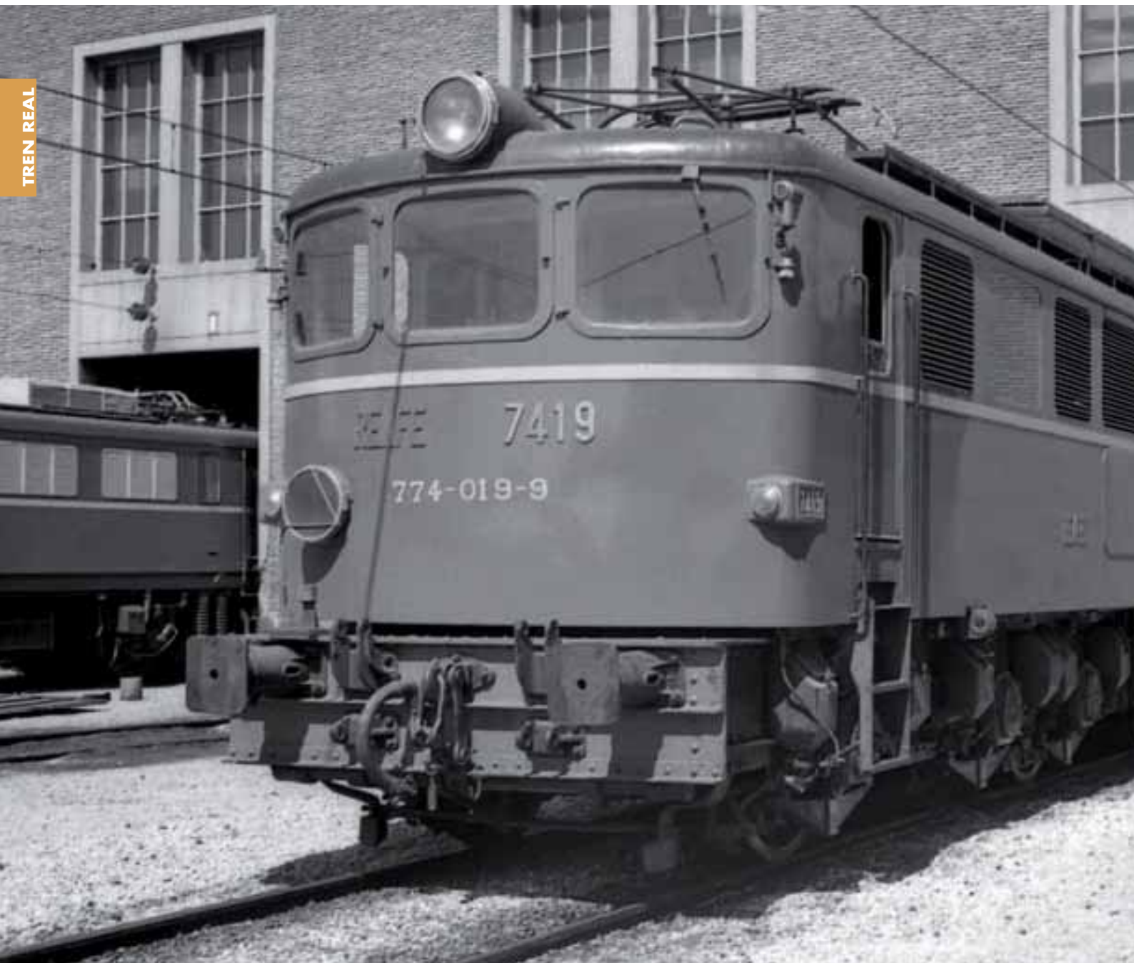
La 7419 recién llegada de reparación en el depósito de Miranda de Ebro, obsérvese la errónea numeración UIC 774 que ostenta la locomotora en lugar de la correcta 274. Foto: JAUME ROCA 11-8-1974
