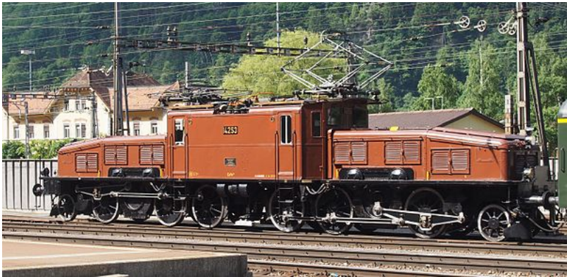
Locomotora "Cocodrilo" SBB Ce 6-8 II; disposición (1'C)(C1')
