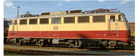
DB-Baureihe E 10; disposición Bo'Bo' (dos bogies tractores)
