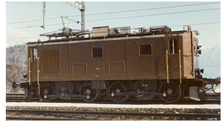
BLS Ce 4/4; disposición B'B' (dos parejas de ejes acoplados)
