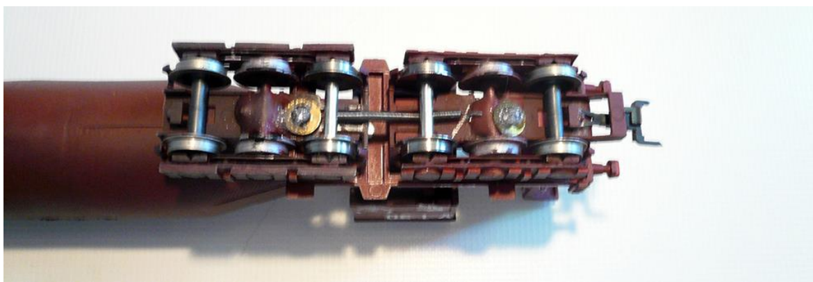
Foto nº 13 - Muelle de unión entre bogies.
