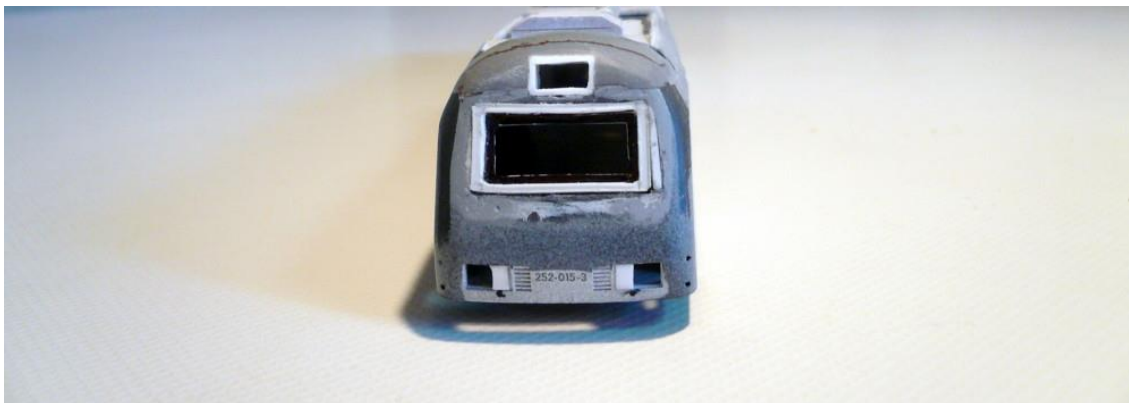
Foto nº 9 – El frontal modificado a falta de retocar y enmasillar.
