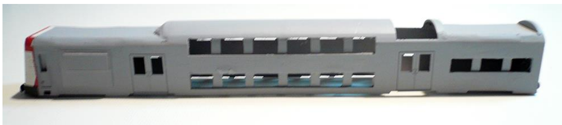
Foto nº 25 - Coche motor con imprimación gris. Lado izquierdo.
