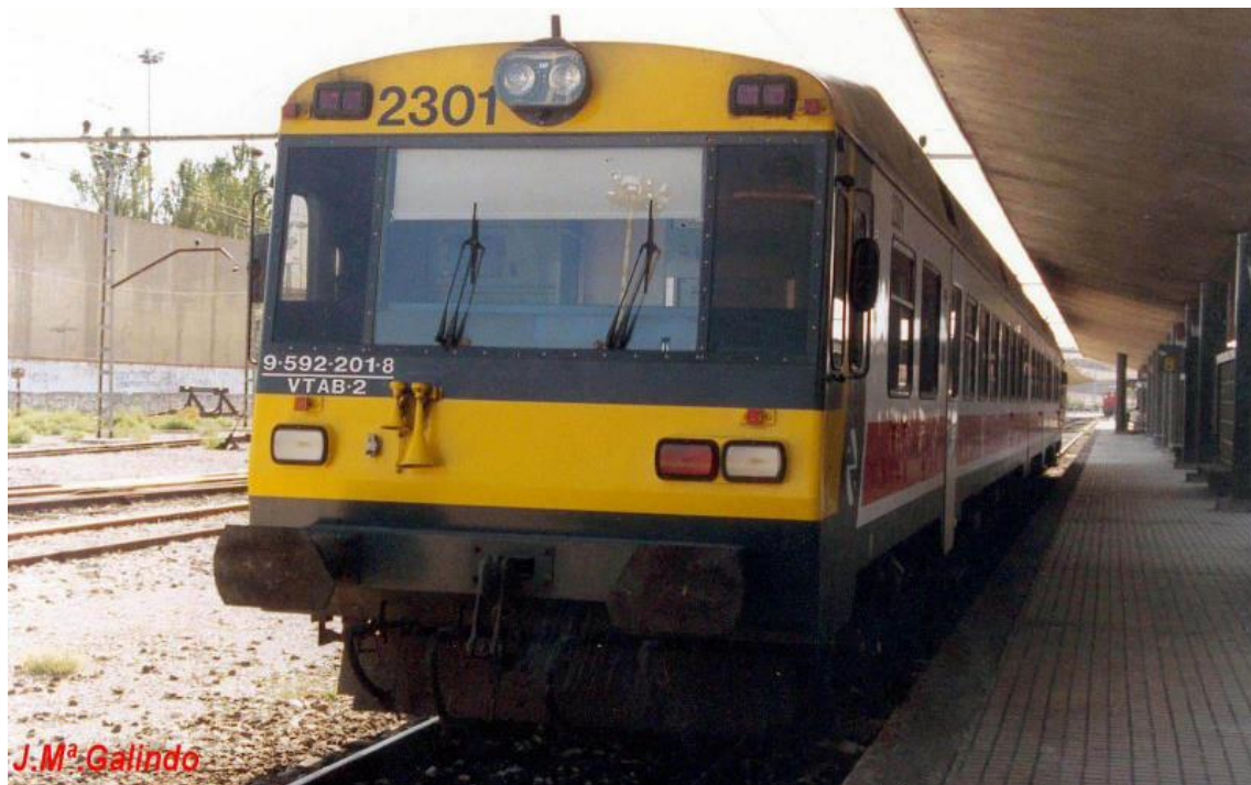
Foto nº 2 – Frontal del remolque reconvertido en coche motor. (Foto J.Mª Galindo).
