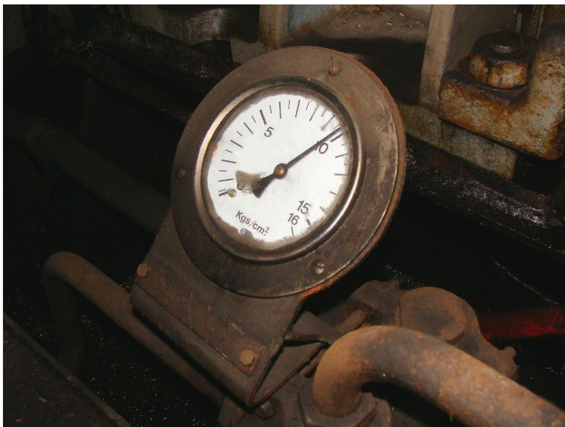
-Vista de Manómetro para la presión del aceite de lubricación del Motor Diésel MD 870/1 perteneciente a la Locomotora Diésel 340-020 de la Renfe (Ex. 4020). 25/10/2014, [Foto: Juan Sánchez Fernandez].
