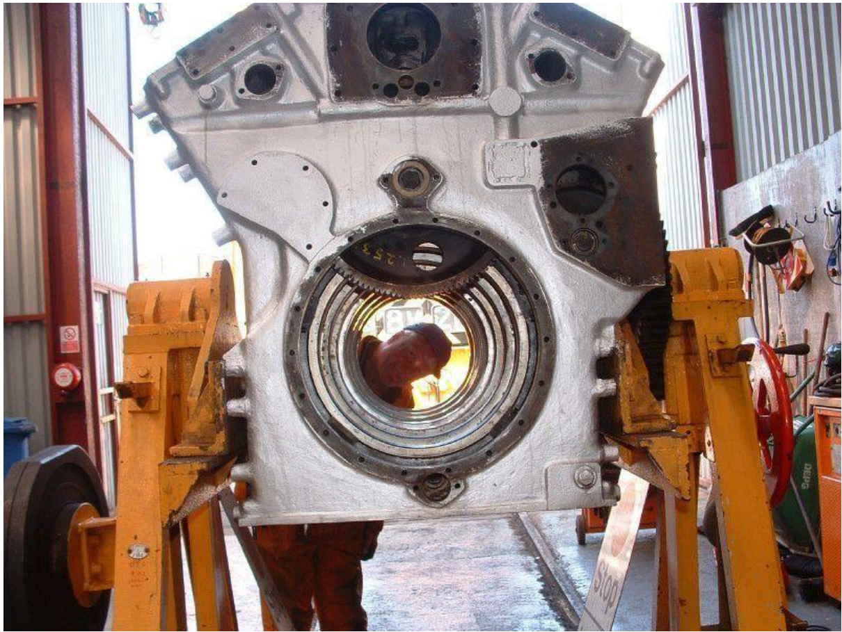
-Vista del bloque motor del MD 870/1 donde se ve el agujero donde va alojado el cigüeñal con rodamientos, el engranaje de la distribución en primer plano y de la bomba de agua.
