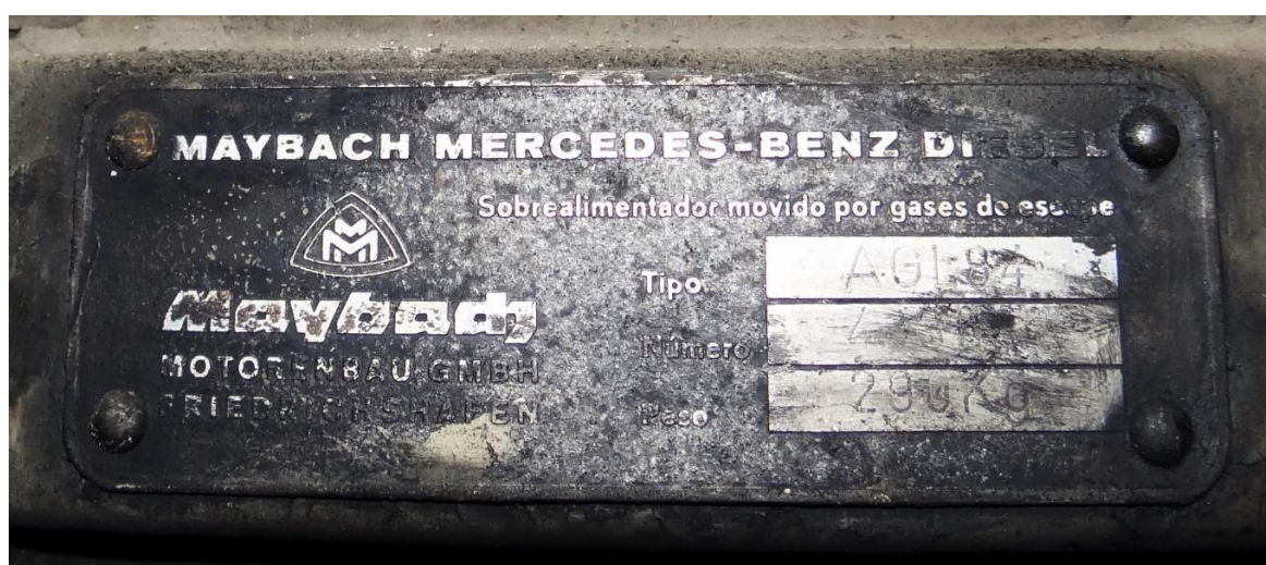
-Placa de construcción del Turbo Sobrealimentador fabricado por Maybach-Mercedes Benz Motorenbau GmbH perteneciente a la Locomotora Diésel 340-020 Renfe (Ex. 4020).
