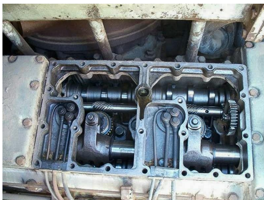
-Vista de una de las tapas abiertas donde se ve el interior de los Balancines e Inyectores del Motor Diésel MD 870/1.
