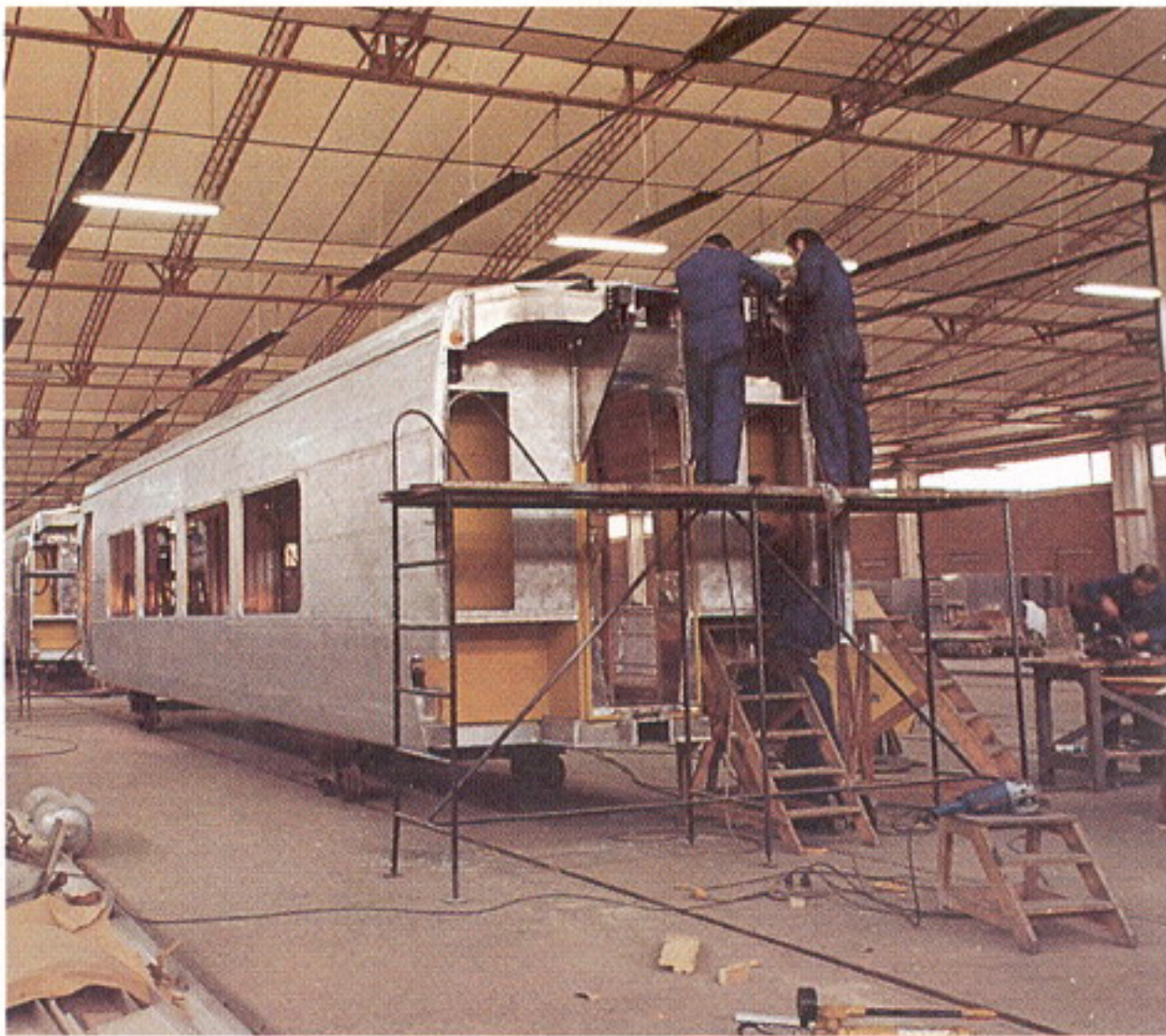
La caja de los coches Talgo está construida a base de extrusiones de aluminio.
