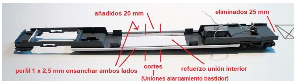
Foto nº 29 – Modificaciones en el chasis JOUEF para la primera motorización Ibertren (sustituida).
