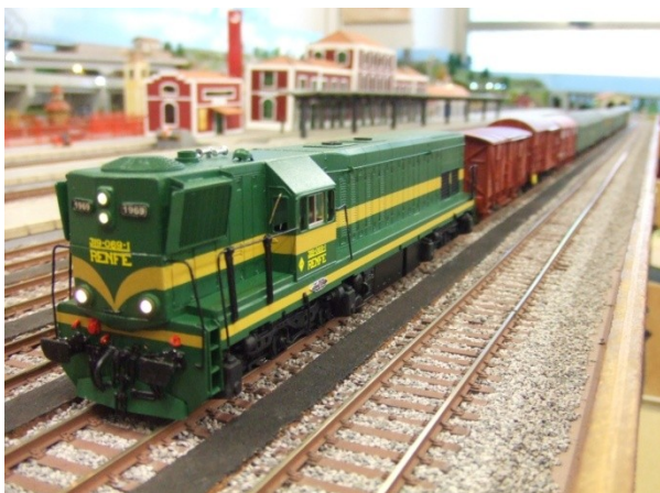
Detalle de las luces frontales blancas o rojas según sentido de circulación.
