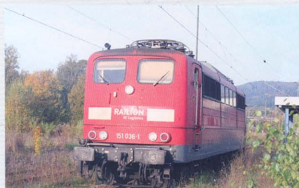
47200 Elektrolok BR 151 DB AG Ep. V mit Einholm-Stromabnehmer
