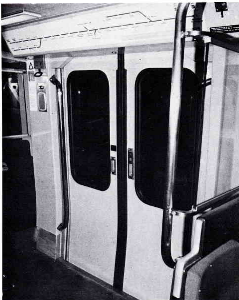
Detalle de una de las puertas desde el interior. Se observan los pulsadores de apertura y cierre, el tirador del freno de alarma y el mando de apertura de emergencia, este último en la parte superior derecha. (Foto VCN)
