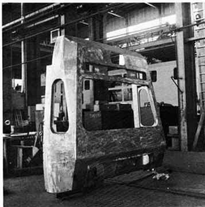
Un tester lateral cabina dispuesto para su unión al resto de elementos de la caja. (Foto VCN).
