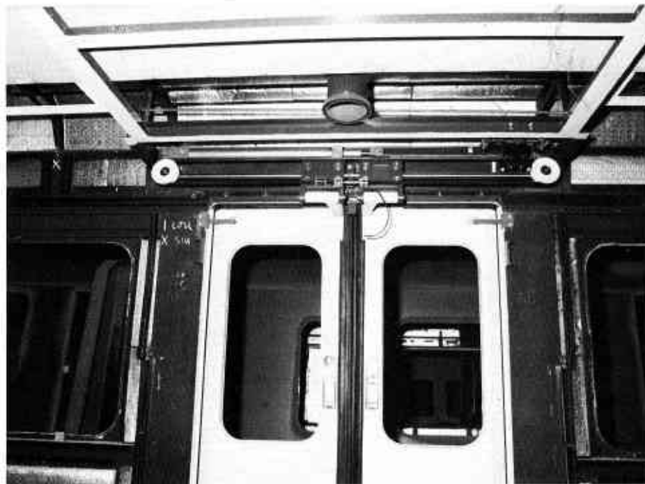
El mecanismo de apertura y cierre de puertas, proyectado y realizado por Macosa. (Foto J. Miquel).
