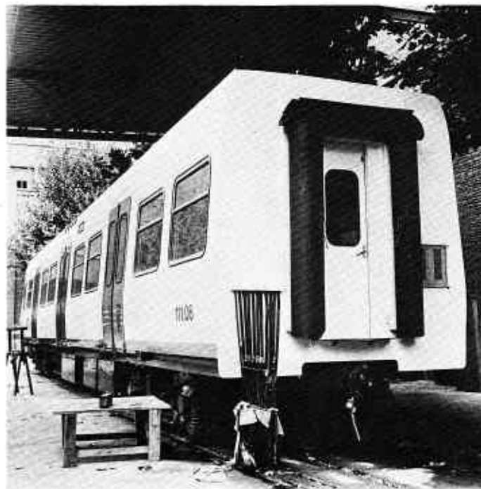
El testero lado intercomunicación de un coche motor. (Foto VCN).
