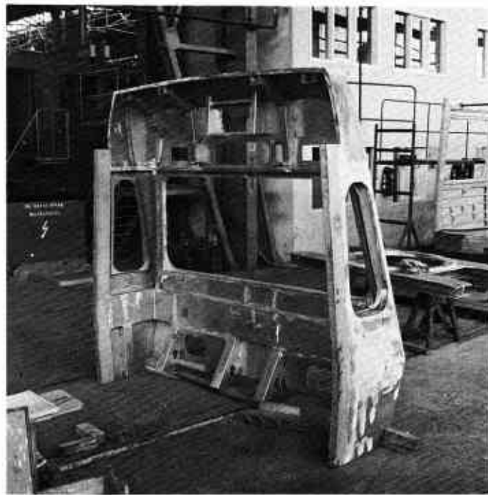
Un subconjunto tester frontal por su parte interior. (Foto VCN).
