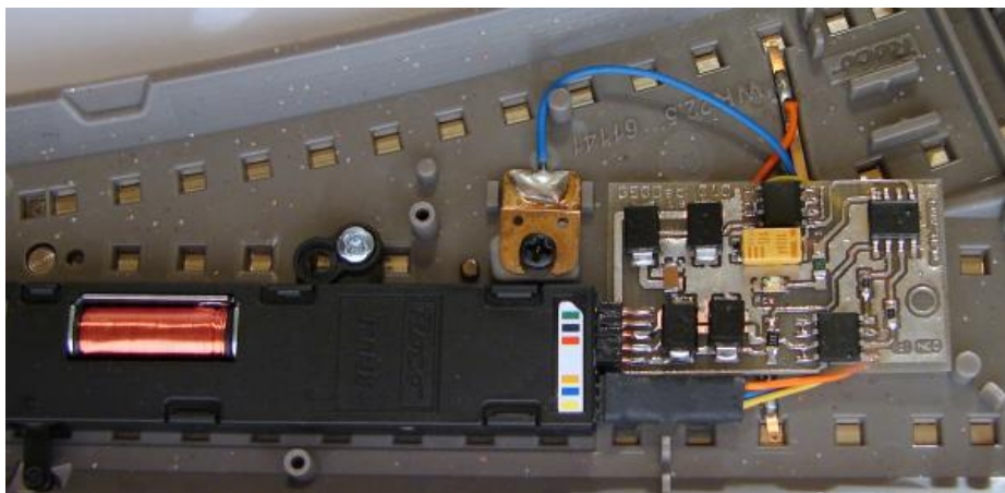
Fig.2 Decodificador GEODec C10 instalado en el interruptor WR
