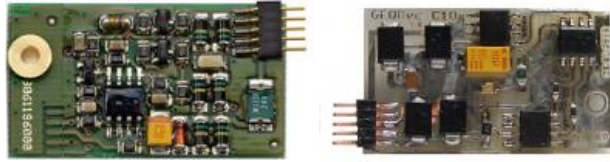
Fig.1 Comparación de decodificadores: a la izquierda Roco 61196, a la derecha GEODec C10
